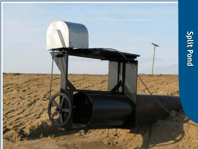
**Figura 8b.** Detalhe do circulador de água usado nos Split Pond, acoplado a um tubo de metal. Observe que nesse caso o circulador força a circulação de água da área de restauração para a área de cultivo (Foto extraída da apresentação de Pomerleau)
