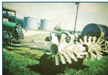
Foto 2. Aerador de pás propelido pela tomada de potência de um trator. Usado em aeração de emergência e pode ser deslocado de um local a outro na piscicultura
