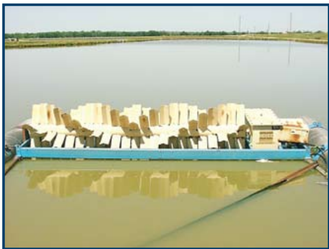
Fotos 1A e 1B. Aerador de pás elétrico de 10 CV usado na aeração de emergência em tanques de cultivo de catfish nos Estados Unidos
