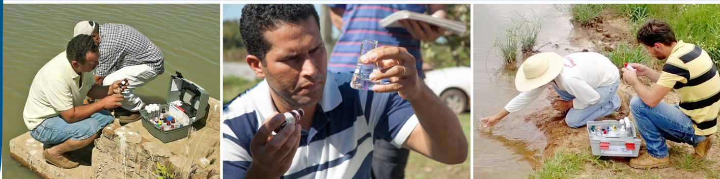
Figura 4. Kits de análises de água permitem aos produtores mensurar, de maneira rápida e de baixo custo, a alcalinidade total, a dureza total e as concentrações de gás carbônico na água
