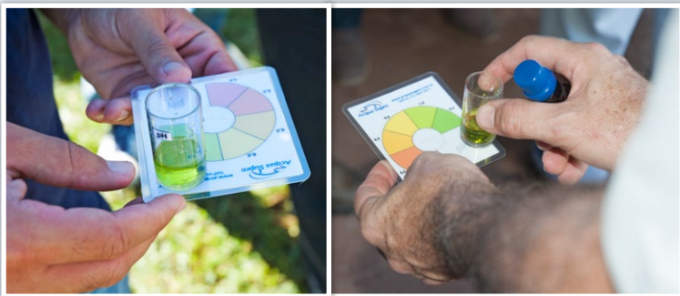
Figura 2. Teste colorimétrico com cartela de cores de pH
