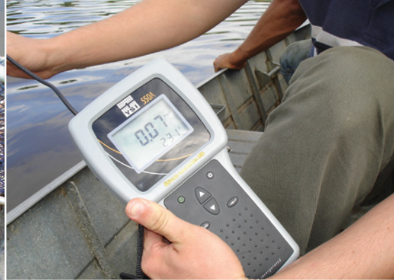
Mortalidade de tilápia em tanques-rede por falta de oxigênio após a ocorrência de uma desestratificação da coluna de água de um açude. Note o valor de 0,07mg/l de oxigênio a 3 m de profundidade
