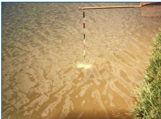
Figura 1. Uso do disco de Secchi para avaliar a transparência em um tanque de larvicultura
