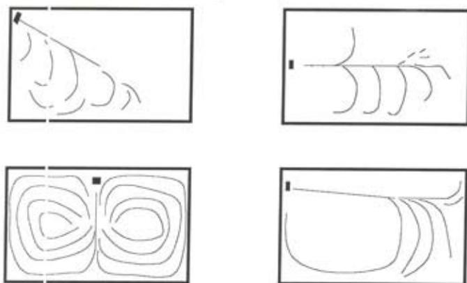
**Figura 4.** Posição de aeradores e circulação de água em viveiros retangulares (Boyd 1990).
